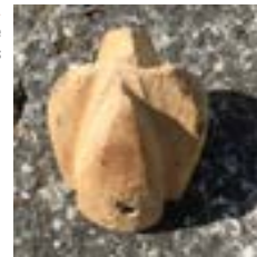
Couchoir ou toupin. Outil de cordier à quatre torons
